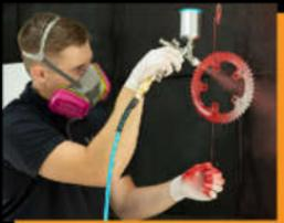
Pour la série H, l'épaisseur du revêtement sera de 25 à 50 microns et la série Elite est de 15 à 28 microns. Ceci est généralement obtenu avec 2 - 3 couches. Le nombre de couches appliquées variera en fonction de la gamme d'épaisseur de lait standard de la couleur, des réglages du pistolet de pulvérisation et de la technique de pulvérisation. Reportez-vous au TDS pour connaître la plage d'épaisseur spécifique à la couleur ou à la série. **Lors de la pulvérisation, la pièce doit sembler humide.**
