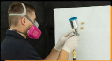
Test des réglages du pistolet de pulvérisation
